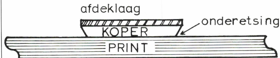
Afbeelding 3. Bij te hoge etstemperatuur of bij te lang etsen treedt er onderetsing op.
